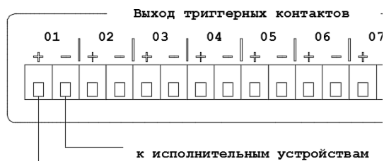
Рис. 3.5. Схема подключения внешних исполнительных устройств к LPA-PRESTA-16.
