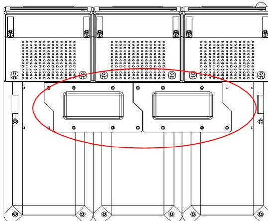
Рис.3.2. Схема крепления LPA-8530TNAS
