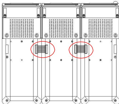
После подключения нужно закрепить модуль расширения с блоком LPA-8530HVNAS или другим блоком расширения с помощью монтажного комплекта (входит в комплект поставки)
