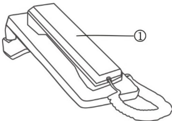
1 – Телефонная трубка для ответа на входящий вызов и совершения двухсторонней связи.
