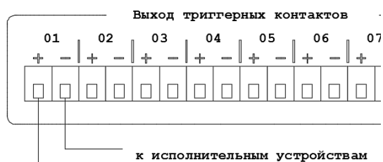
Рис. 3.5. Схема подключения внешних исполнительных устройств к LPA-PRESTA-16.
