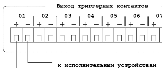
Рис. 3.5. Схема подключения внешних исполнительных устройств к LPA-PRESTA-16.
