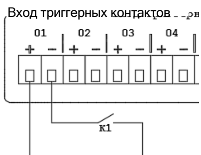
Рис. 3.4. Схема подключения внешних сигналов управления к LPA-PRESTA-16 без контроля целостности.
