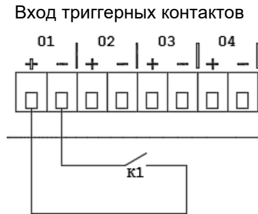
Рис. 3.4. Схема подключения внешних сигналов управления к LPA-PRESTA-8 без контроля целостности.
