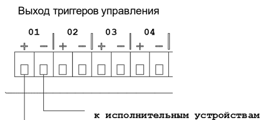
Рис. 3.5. Схема подключения внешних исполнительных устройств к LPA-PRESTA-8.
