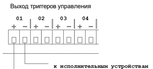
Рис. 3.5. Схема подключения внешних исполнительных устройств к LPA-PRESTA-2.
